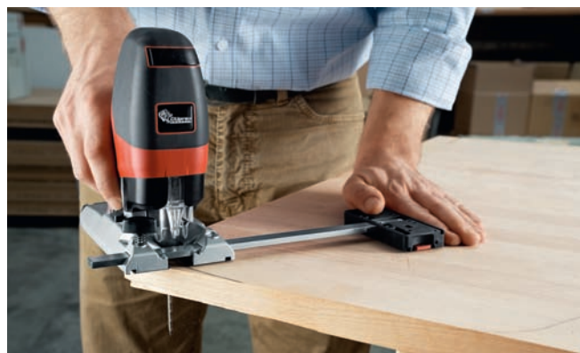
Auch zwangsgeführte Schnitte geraten mit der P1 cc von Mafell absolut rechtwinklig
