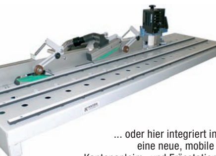
Vielseitigkeit des Kantenknirps: hier als mobiles Gerät mit Handgriff ...
